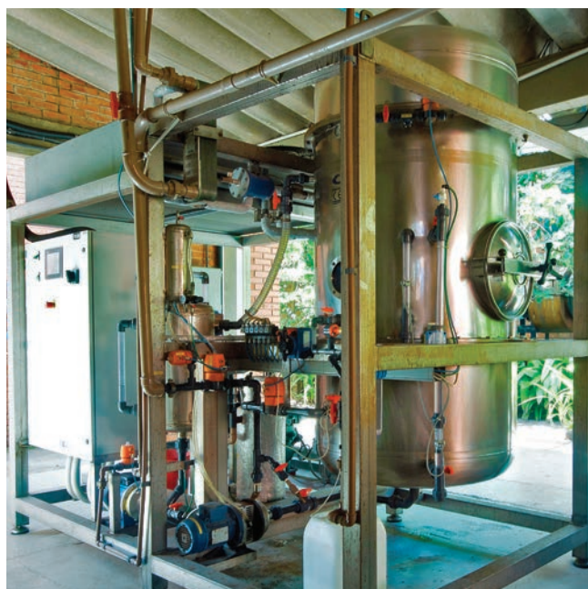
Evaporador a Vácuo para eliminação dos contaminantes químicos e desmineralização de efluente.
